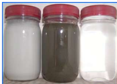
原水 釜残渣 回収水
