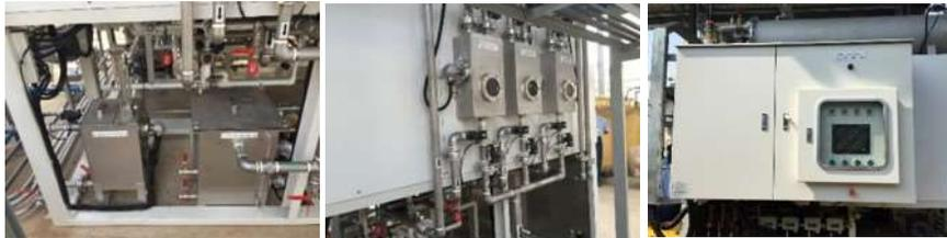
新規製品製造工程を導入するにあたり、廃液処理を検討。様々な方式を試したが、COD数値がネックとなり最終的に減での処理を選択。回収水は後段で生物処理を採用。廃液には低沸点溶剤が含まれており、初留分を15%カットする事で回収水のCOD値を抑制している。
