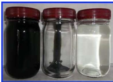
原水 釜残渣 回収水
