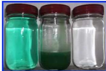
原水 釜残渣 回収水
