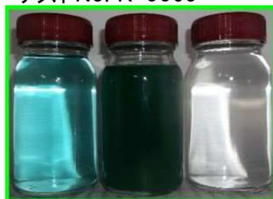
原水 釜残渣 回収水
